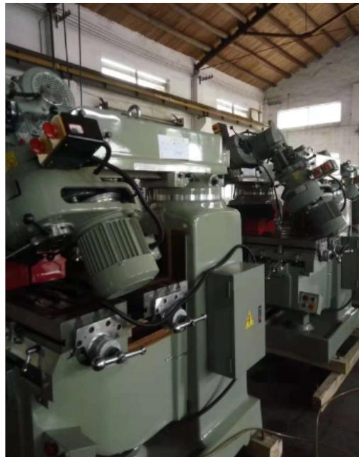
二手炮塔铣床是一种轻型通用金属切削机床，具有立、卧铣两种功能，可铣削中、小零件的平面、斜面、沟槽和花键等，普遍应用于机械加工、模具、仪器、仪表等行业。提升炮塔铣床工作效率的方法有哪些？1. 以工作台带动工件移动，高速主轴带动刀具旋转进行切削。2. 当炮塔铣床停止运作时，做好保养维护。3. 操作时不要加工超过铣床能力范围的工件，以免造成机器故障。4. 依据粗精别离的原则，对加工过程进行区别。5. 对铣床夹具进行区别，合理使用。6. 根据刀具设备原理区分加工进程，削减刀具的行程改动。
