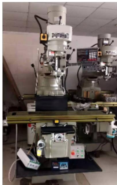
铣床在模具制造和加工中起着非常重要的作用。如模板加工需要铣床，如模板六面铣削、模板导柱孔铣镗、模具型腔加工等。然而，大多数模具型腔都是在数控铣床或加工中心加工的。铣床是机械加工中应用普遍的机床之一。主要用于精加工，偶尔用于初加工。在模具加工中，一般采用车床进行回转体加工，可根据高精度要求增加磨床；在非回转体加工中，多采用铣床。尤其是在大平面的精加工中。（粗加工用刨床，高精度加工用磨床）。此外，在侧面加工、沟槽加工方面，铣床也有其优势。吉林数显炮塔铣床多少钱炮塔铣床立铣刀如何选型？
